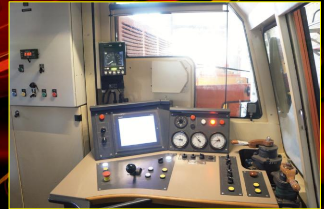
Пульт управления тепловозом
